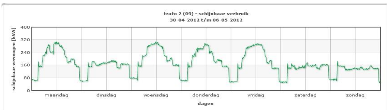
Figuur 15: Het gedrag van het schijnbaar vermogen van transformator 2 gemeten gedurende een week
