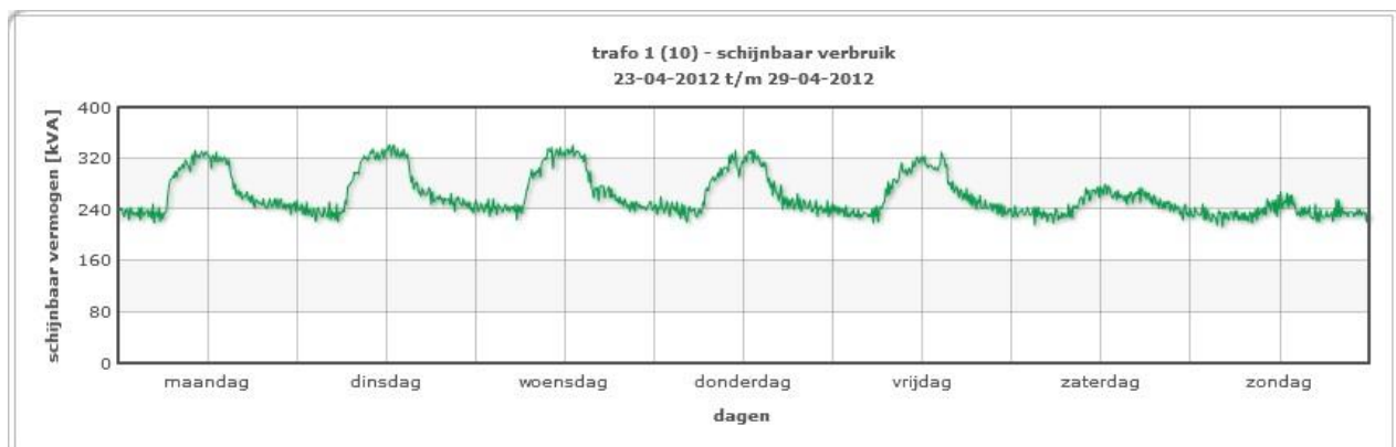
Figuur 9: Het gedrag van het schijnbaar verbruik van transformator 1 gemeten gedurende een week
