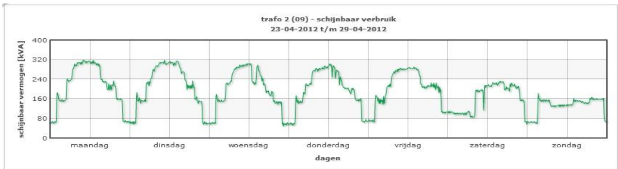
Figuur 13: Het gedrag van het schijnbaar vermogen van transformator 2 gemeten gedurende een week
