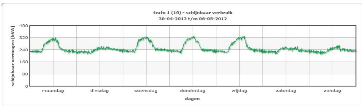
Figuur 11: Het gedrag van het schijnbaar vermogen van transformator 1 gemeten gedurende een week
